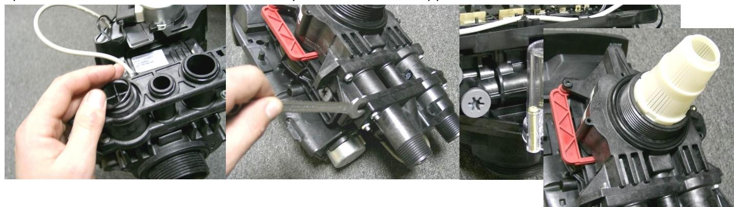
4. Закрепите на клапане верхнюю распределительную сетку.
