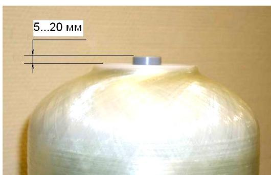
Убедитесь, что корпус установки пустой и чистый. Иногда, при отрицательной температуре, внутренняя оболочка напорного баллона может отслаиваться от наружного слоя нитевой намотки. Это не является браком баллона. При нагревании и подаче давления, плотность соединения оболочек восстановится.
