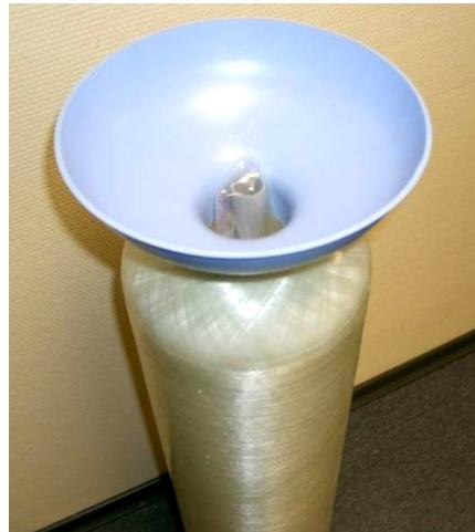
7. Засыпьте смолу в баллон. По окончании загрузки он должен быть заполнен приблизительно на 67% от своего объема. Снимите воронку и защитную пленку. Очистите торец и резьбовую часть баллона от крупинок смолы.
